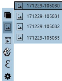
Como se muestra en la figura, presione la tecla “Izquierda” para acceder a la lista de imágenes. Utilice las teclas de navegación “Arriba” o “Abajo” para seleccionar la imagen deseada. Luego, presione la tecla “SELECT” para visualizarla.
