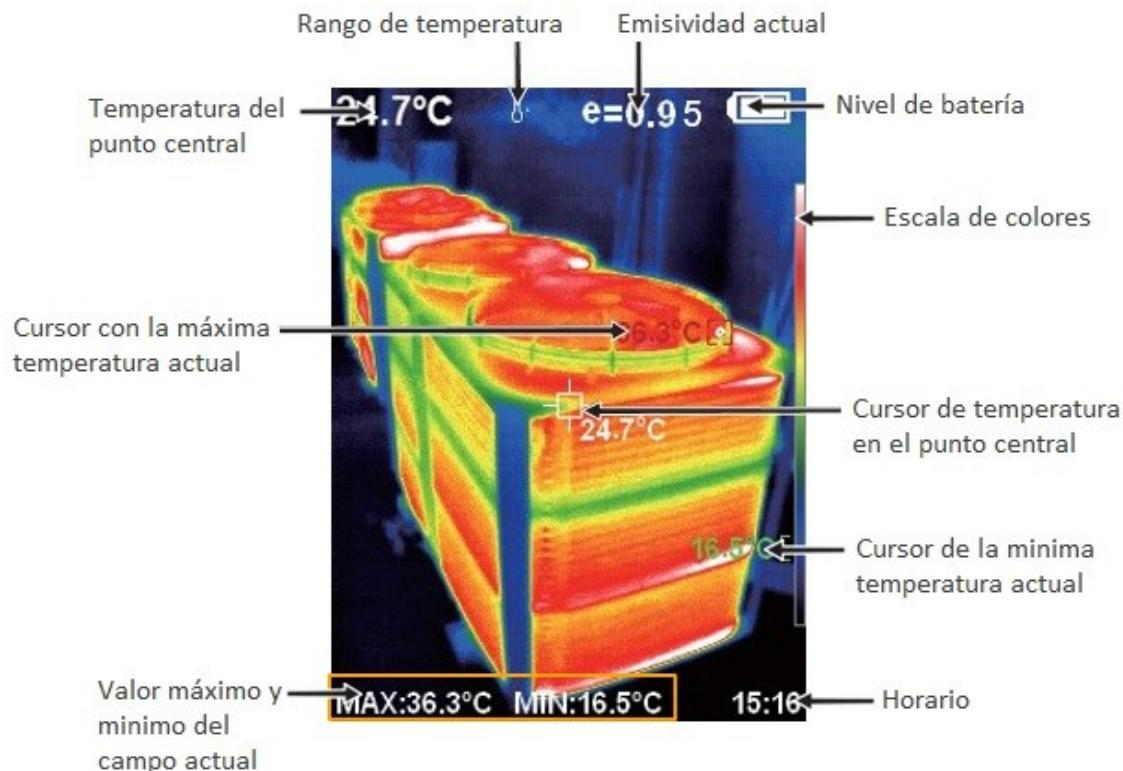
Rango de temperatura: Indica el intervalo de temperaturas que puede medir el dispositivo.
