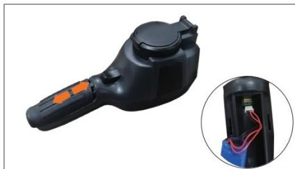
Asegúrese de deslizar la tapa de la batería hasta la posición correcta en el mango del dispositivo.
